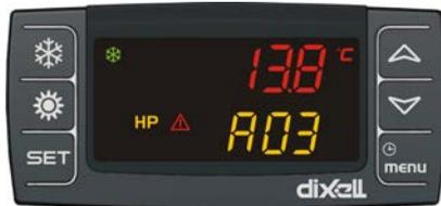
Quand le régulateur détecte une alarme, l'afficheur inférieur indique le code d'alarme en alternance avec la valeur de la sonde. L'icône d'alarme (
