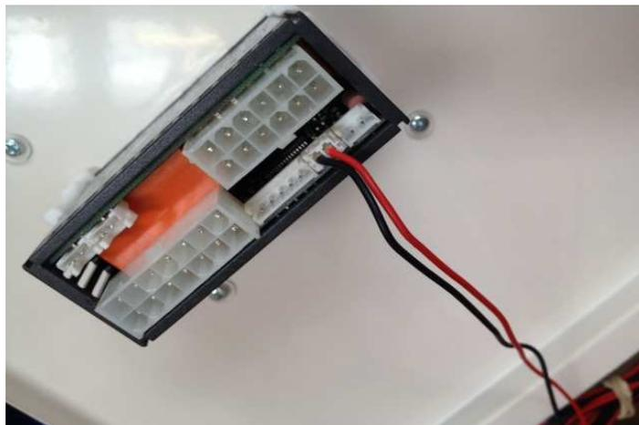
10 - Positionner les 2 autres connecteurs sur le régulateur Dixell.
