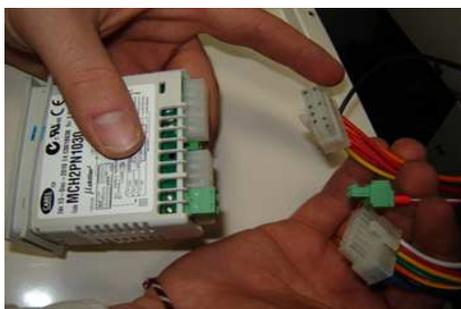
4 - Retirez le régulateur de son socle de fixation en pressant sur les ailettes
