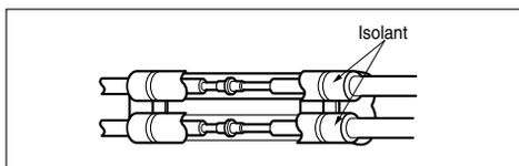
2. Enveloppez la zone de raccordement à l'arrière des tuyauteries avec du ruban vinyle.
