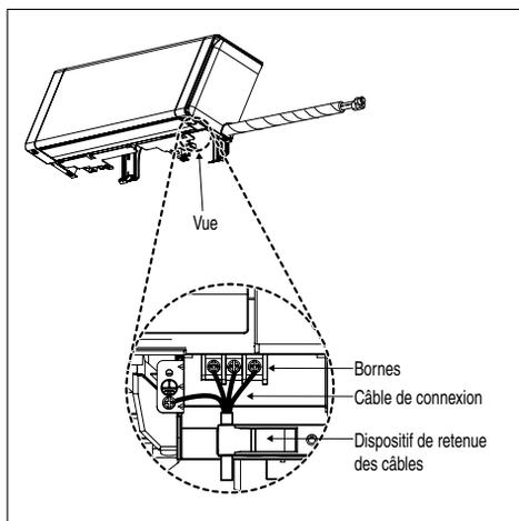
2. Fixez le câble au tableau de commande à l'aide de l'attache-câble.
