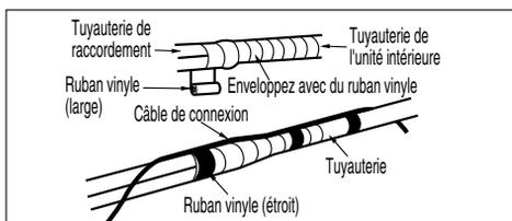
3. Regroupez les tuyauteries et le flexible d'évacuation en les enveloppant à l'aide de ruban vinyle sur toute la longueur de leur raccordement à l'arrière de l'unité.
