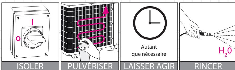
Éteindre le système. Isoler les circuits électriques. Pulvériser EasyFoam™ à l'intérieur du serpentin, en commençant par le bas puis en allant de droite à gauche et progressivement vers le haut. Très vite le produit se met à mousser, la mousse augmente de plus en plus et force les saletés à se détacher. Le produit est encore plus efficace si on l'utilise sur un serpentin encore tiède. Après le nettoyage, rincer abondamment à l'eau claire.
