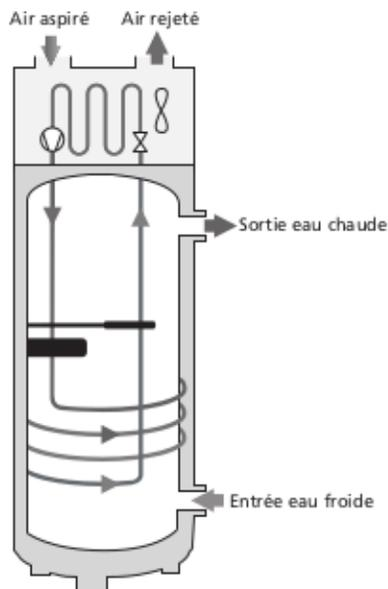
Le chauffe-eau thermodynamique utilise l'air extérieur pour la préparation de l'eau chaude sanitaire.
